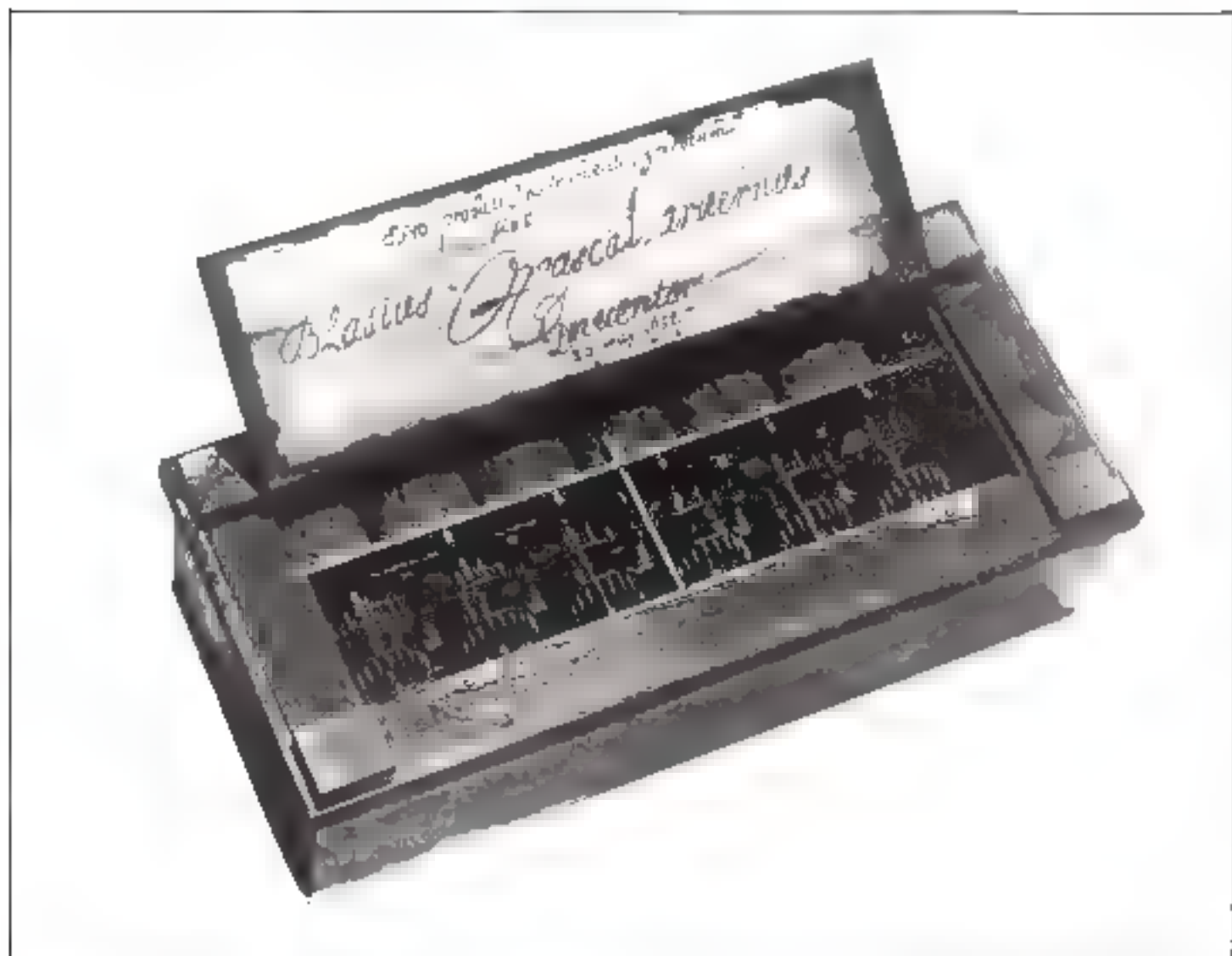
Blaise PASCAL, en 1642, réalisa une des premières machines à calculer. Au cours de la machine les chiffres mécaniques d'addition agissent sur de petites roues gravées de chiffres, avec un système de report des retenues à base d'engrenages (faisant avancer des roulettes rotatives).
